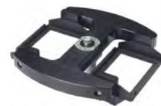
max. Volume: 2 x 3 Microtitreplates Order number: 221.16 V03
